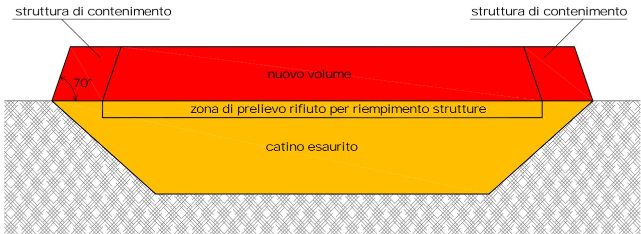
Sopraelevazione con "Struttura di contenimento" di una discarica a catino esaurita
