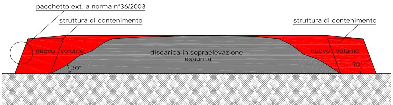
c) Riattivazione mediante sistemazione ed ampliamento "plano-altimetrico"
