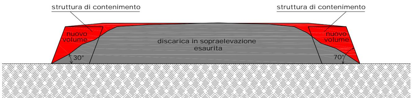
b) Ripristino e chiusura con recupero volumetrico "altimetrico"
